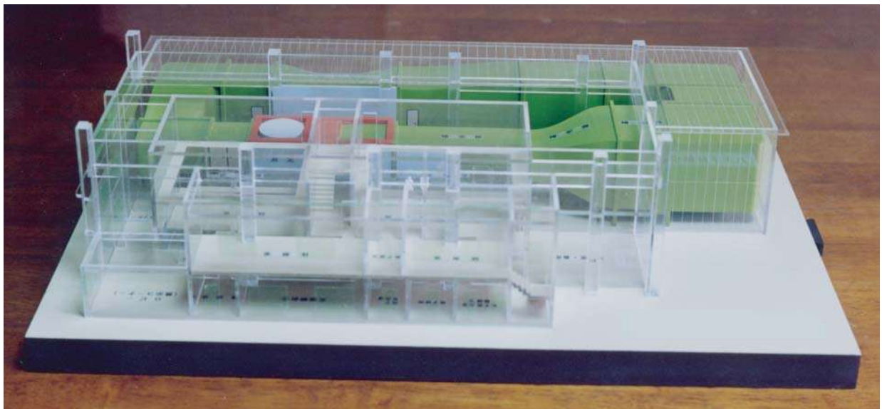
<装置紹介模型 乱流境界層風洞> 縮尺：1/100
